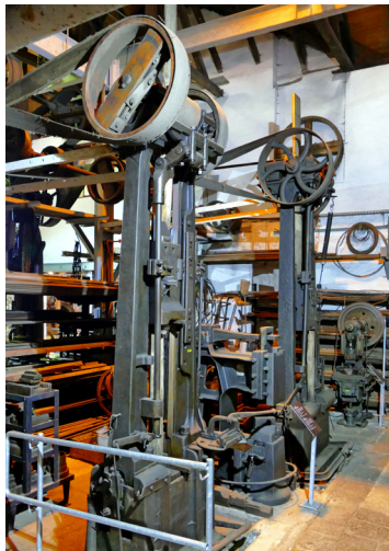
Der älteste Brettfallhammer Deutschlands (Baujahr 1867) hat bis 1917 in der Königlich Preußischen Gewehrfabrik in Erfurt gearbeitet.
